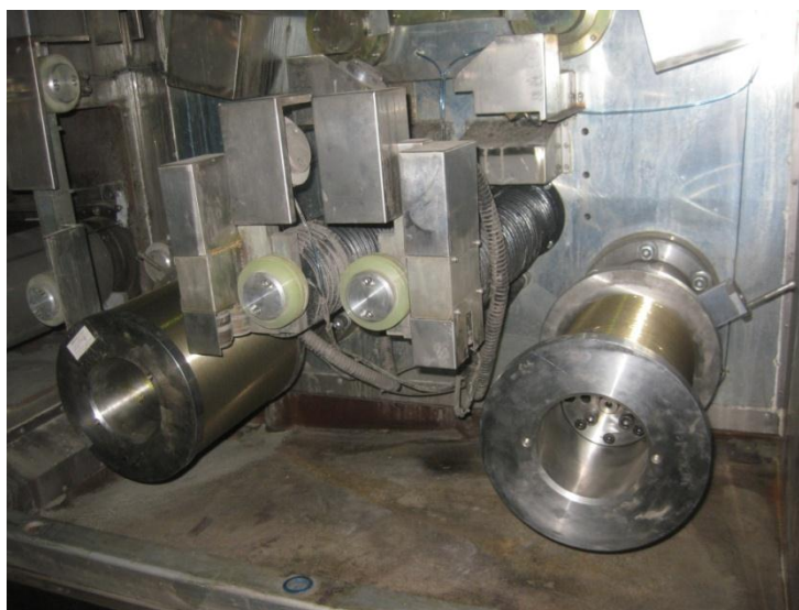
شکل ۱۹: دستگاه اسلایسر بالک سیلیکون و تولید ویفر خام
