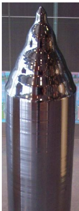
شکل ۱۸: نمونه استوانه سیلیکون مونوکریستالی تولید شده به روش Czochralski process
