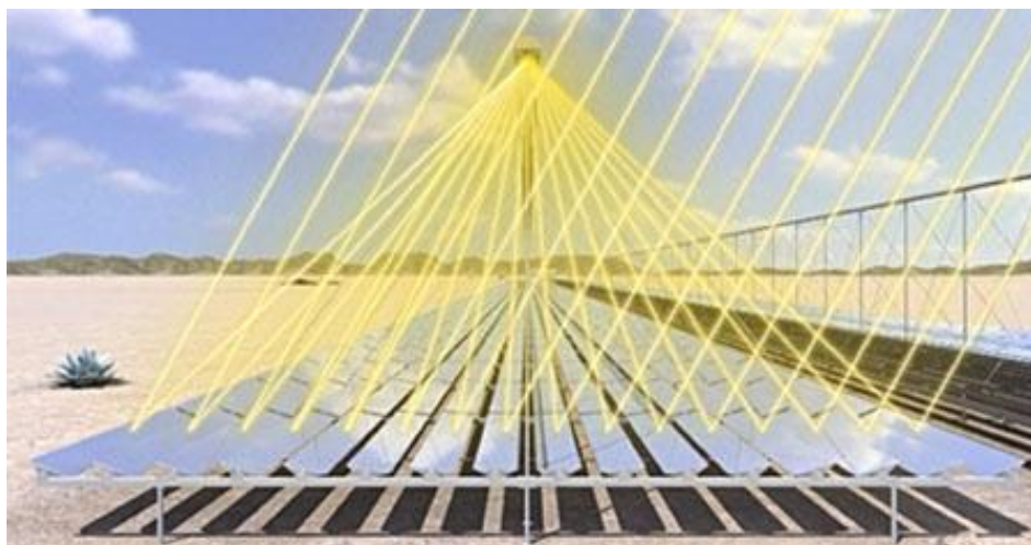
شکل ۶۳: شماتیک عملکرد سیستم فرنی انعکاسی [14]
